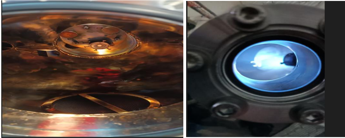
Figura 1.4: Imagini ale camerei de vid (stânga) și ale unui experiment de depunere cu laser pulsant de ZrO_2 în desfășurare (dreapta) [INFLPR]
